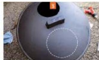
**1** Découper intégralement le fond de la poubelle plastique à l'aide d'une scie sauteuse ou d'un autre outil **2** Découper une jambe de pantalon (à ¼ de hauteur). Cette dernière permettra de charger l'augmentorium en fruits tout en servant de sas pour éviter la sortie des mouches **3** Découper deux trous en cercle dans le couvercle de la poubelle. Le premier d'un diamètre de 14 cm, le second de 20 cm
