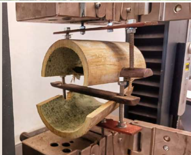
De haut en bas : d'après les architectes du futur lycée, « les façades en bambou évoquent le tressage des clôtures des habitats mahorais ». © Jeudi Wang | Vérification manuelle des bambous. © HHK | Test de résistance du bambou à la traction perpendiculaire. © C&E
